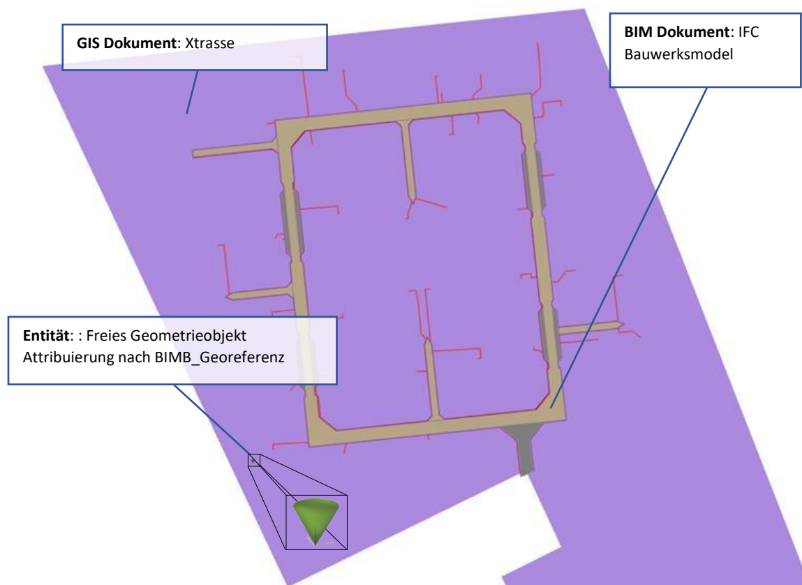
Abbildung 3: Georeferenzierung des Breitbandmodells zur Integration von BIM- und GIS-Planungsunterlagen.
